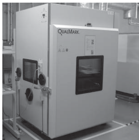
図9. HALT 試験機 — この試験機は、急激な温度変化とランダム振動を同時に製品に加え、製品に内在する品質改善点を短時間に抽出できる。
