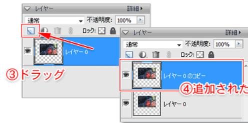
3. [レイヤー]パレットの[レイヤー0]を、[新規レイヤーを作成]ボタンにドラッグ&ドロップします。
