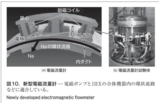
図10. 新型電磁流量計 — 電磁ポンプとIHXの合体機器内の環状流路などに適合している。
