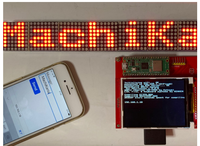
WiFi対応のRaspberry Pi Pico WでスマートフォンからLEDマトリクス表示機を制御
