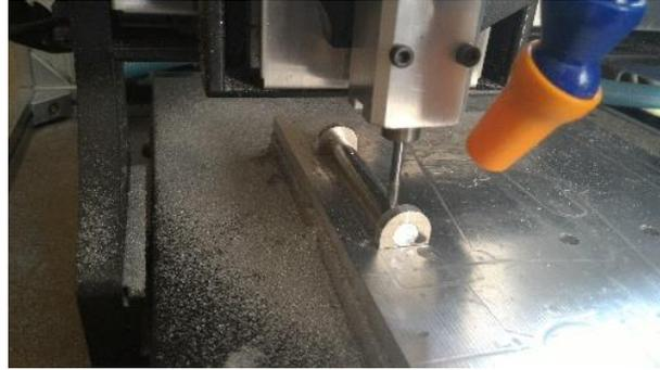
図8 CNC卓上フライスでのキー溝加工
