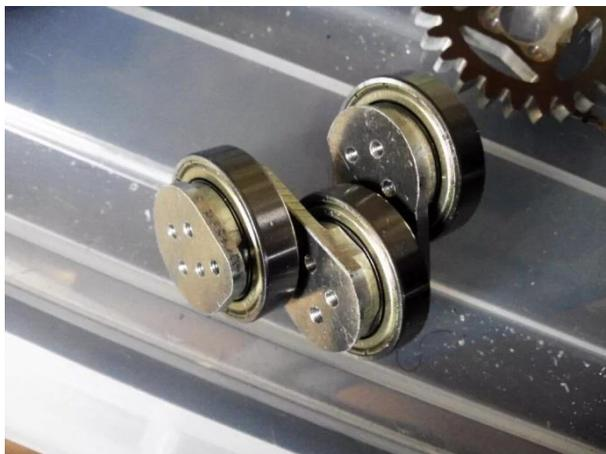
図 3 脚用クランク機構
