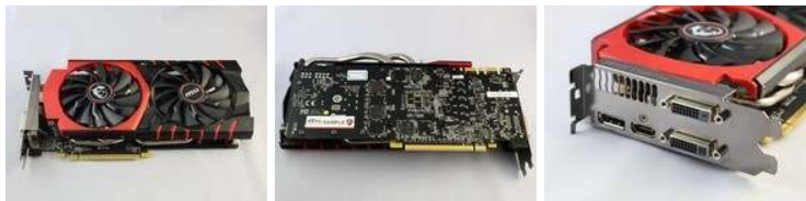
大口径ファンを2基備えるMSI独自のGPUクーラー「TWIN FROZR V」を搭載。低負荷時はファンが自動的に停止する
