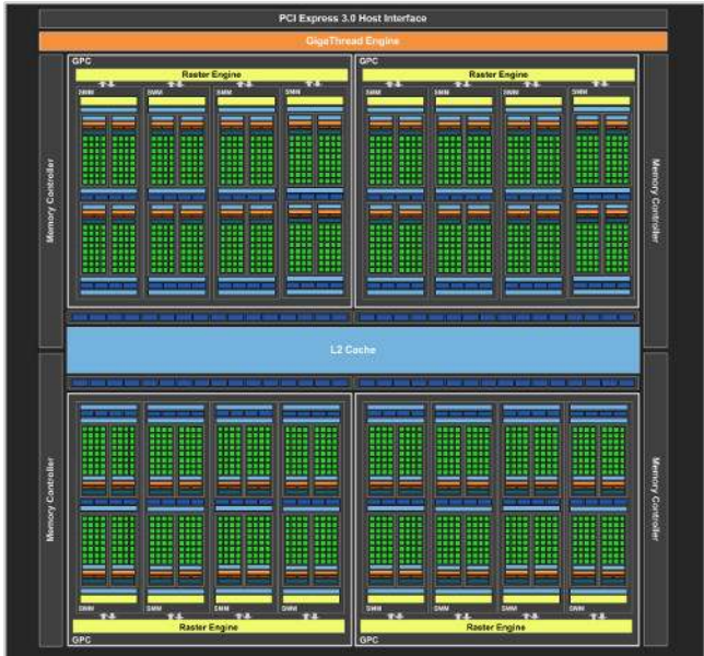
GeForce GTX 980のブロックダイアグラム
